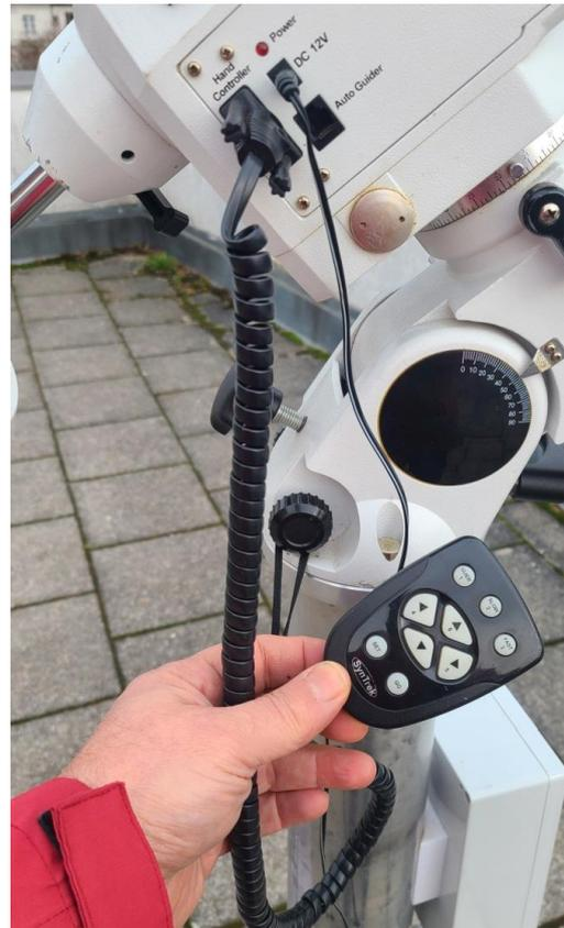
Mit „**SLOW**“ und „**FAST**“ kann sowohl bei normalen Nachführ-Modus, wie auch bei der Schnell-Bewegung die Geschwindigkeit der manuellen Bewegung über die Pfeiltasten verlangsamt bzw. beschleunigt werden.
