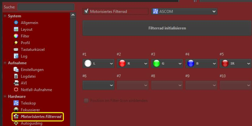
Steht ein elektrisches Filterrad zur Verfügung, können ganze Serien vollautomatisch aufgenommen werden, da mit entsprechenden Treiber das Filterrad über FireCapture gesteuert werden kann.
